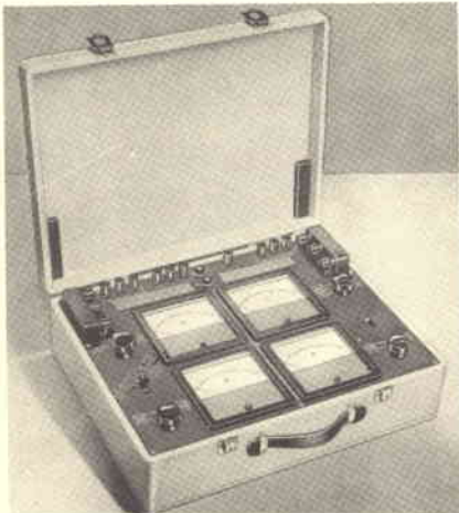
Fig. 10 - Strumento portatile delle Officine Galileo per elettrotecnici per la misura delle tensioni alternate da 50 a 600 V, delle correnti da 0,3 a 300 A e della potenza da 0,05 a 180 kW (monofase e trifase).
