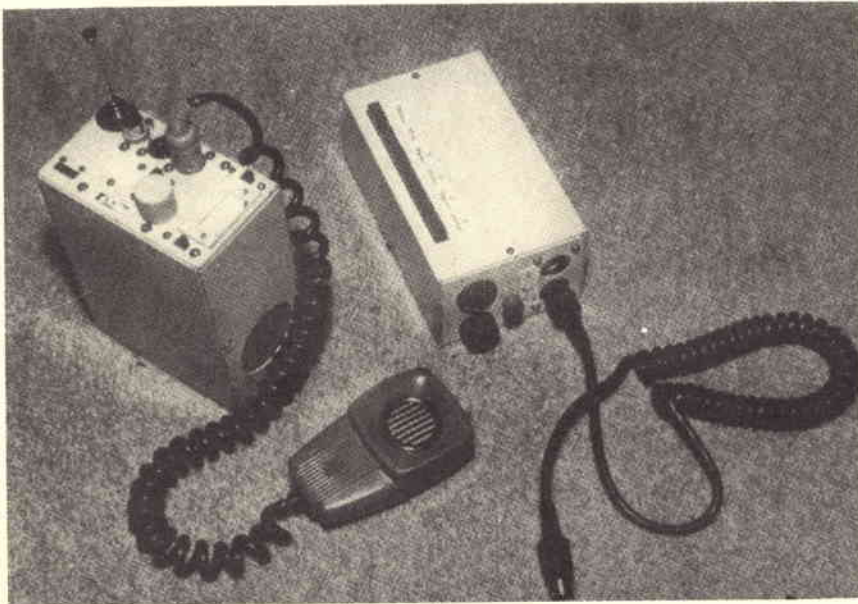
Fig. 7 - Fotografia illustrante il rice-trasmettitore e la relativa sezione di alimentazione e di ricarica delle batterie, a realizzazione ultimata.
